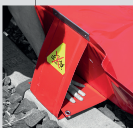
Vanu je možné umístit pod vlak nebo jiné drážní vozidlo dvěma způsoby: napříč přes koleje nebo podélně do vnitřního prostoru mezi kolejemi. Oba způsoby použití byly podrobeny náročným testům.
